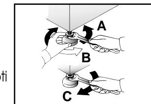
c) Upevněte polohu nožičky otočením matice šroubu proti směru hod. ručiček.
