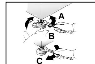
Примечание: рекомендуем сохранить поперечную скобу и винты, чтобы заблокировать машину в случае возможной будущей транспортировки. Производитель не несет ответственности за любые возможные повреждения машины по причине невыполнения правил касающихся транспортного крепежа. Установка изделия производится за счет владельца машины.
