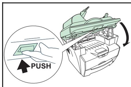
**ВАЖНО:** При закрывании сканирующего блока соблюдайте осторожность, чтобы пальцы не попали между блоком и основным корпусом аппарата.
