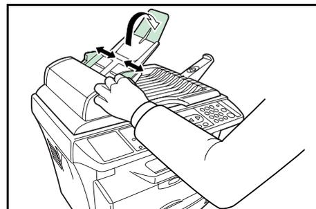
**4** При использовании размера A4 выдвиньте удлинитель выходной панели.
