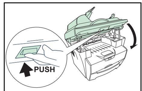
**ВАЖНО:** При закрывании сканирующего блока соблюдайте осторожность, чтобы пальцы не попали между блоком и основным корпусом аппарата.
